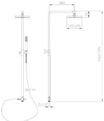
Colonna doccia telescopica completa di deviatore automatico e supporto a muro, soffione e doccia con ugelli anticalcare.
