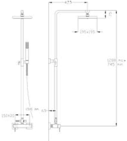
Colonna doccia telescopica completa di miscelatore doccia ottone con deviatore automatico, soffione e doccia con ugelli anticalcare.
